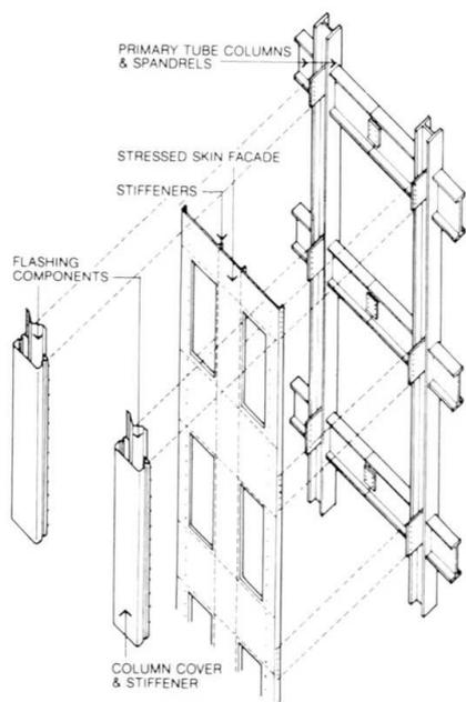
FIGURE 11 - EXTERIOR WALL SYSTEM
