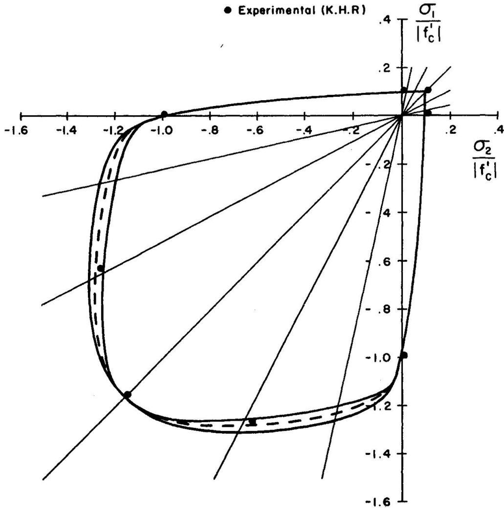
Fig. 5 Biaxial Tests of Kupfer et al
