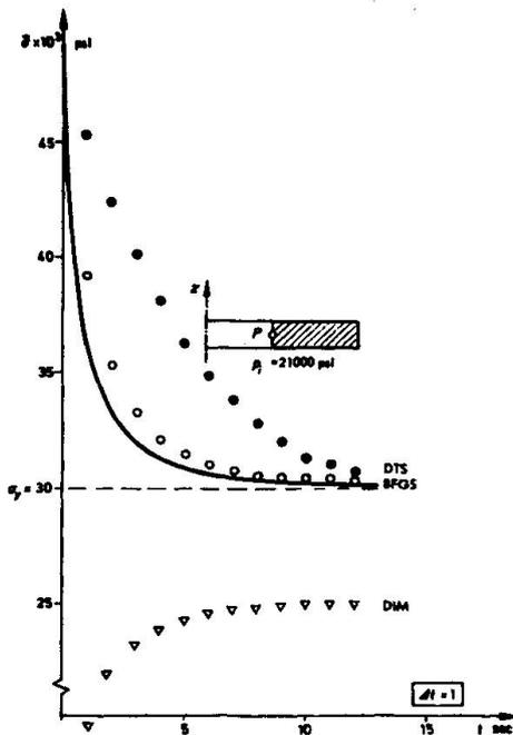
Fig. 10: EQUIVALENT STRESS HISTORY AT THE INSIDE WALL
