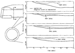
FIGURE 8. COMPARISON OF LONGITUDINAL STRAIN/TIME HISTORIES AT TUBE CROSS-SECTION
