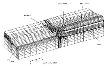
FIGURE 2. FE MODEL OF S4 TEST, COORDINATES SYSTEM.
