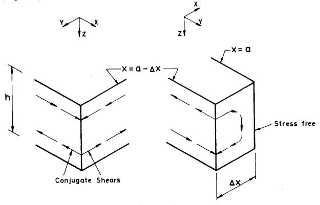
Figure 3. Isolation of Edge Strip.
