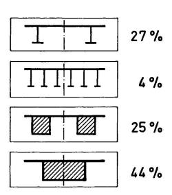
Fig. 3 Stahlbau: Grundquerschnitte der Quersysteme. Anwendungshäufigkeit
