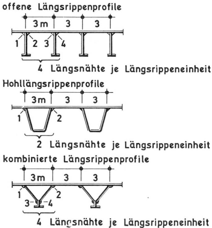
Fig. 4 Stahlleichtfahrbahnen
