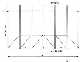
Bild 16 Mögliche Anlieferungsformen eines Windverbandes
