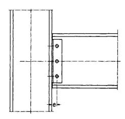
Bild 9a Verschraubter Stirnplattenanschluss
