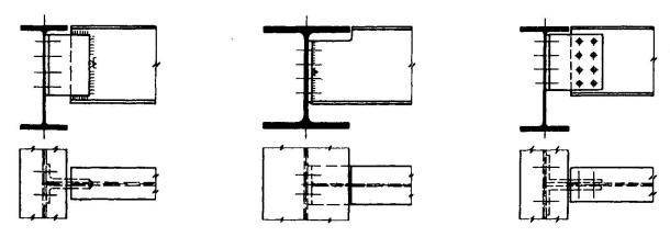
Bild 10 Typisierte "gelenkige" Anschlüsse von Sekundärträgern
