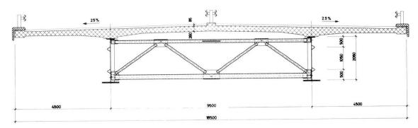
Bild 21 Querschnitt einer Verbundbrücke (CH); Spannweite max 43,50 m
