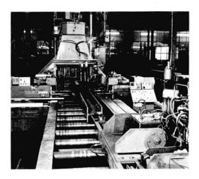
Bild 8 Numerisch gesteuerte Bohranlage
