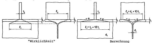
Bild 3 Kraftverteilungen in einem Walzprofil
