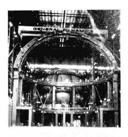
Bild 20 Stahlgerüst für die Fertigung von Alu-Kugelbehältern
