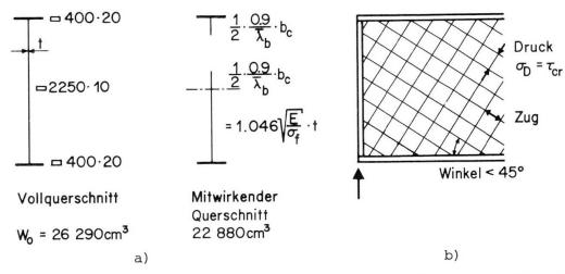
Bild 4 Tragmodelle für Biegung und Schub im überkritischen Beulbereich
