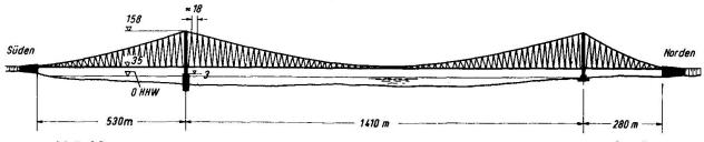
Bild 17 Ansicht der Hängebrücke über den Humber bei Hull (nach [26])
