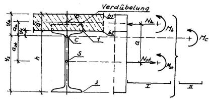
Bild 3. Stahlträgerverbundquerschnitt und Anteil der Schnittlasten
