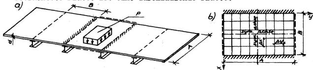
Bild.2. Stahlträgerverbunddecke. a) Ansicht, b) Schema der Auflagerung der Betonplatte und eine Gitterverteilung zur numerichen Berechnung
