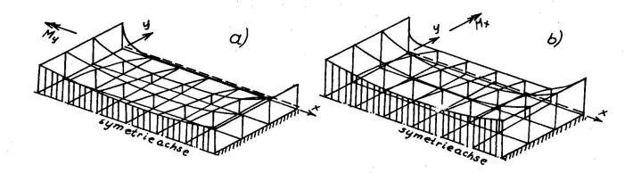
Bild 4. Biegungsmomente als Folge des Temperaturunterschiedes längs der Spannweite. a)  $M_X$  - Momente, b)  $M_y$  - Momente
