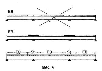
die Verbundwirkung mit den Trägern auf der ganzen Länge ein, indem man eine künstliche Pressung oder eine verstärkte Bewehrung der Stahlbetonplatte in den Zugzonen verwendet. Eine weitere Möglichkeit besteht im Einsatz von Stahlbeton ausschließlich in den Druckzonen, während in den Zugzonen eine orthotrope Stahlplatte vorgesehen wird (Bild 4).
