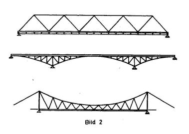
Ein weiteres Beispiel für die Realisierung des Prinzips der Funktionsüberlagerung im sowjetischen Brückenbau sind kombinierte Fachwerke, das heißt eine vollkommene Vereinigung der Längsbalken der Brückenfahrbahnen mit den in Höhe der Fahrbahn angeordneten Gurten der Hauptbinder. Die kombinierten Fachwerke finden in der UdSSR, besonders bei der Errichtung von Autobahn- und Rohrleitungsbrücken, breite An-wendung (Bild 2).
