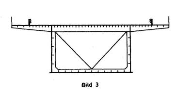
In der oberen orthotropen Platte vereinigen sich die Funktionen der Fahrbahn, der oberen Gurte der Hauptträger sowie der oberen Verbände, in der unteren Platte die Funktionen der unteren Gurte der Hauptträger und der unteren Verbände. Bei derartigen Bauwerken werden in hohem Maße die Gewichtsund Betriebskennziffern im Vergleich zu analogen älteren Konstruktionsformen verbessert.
