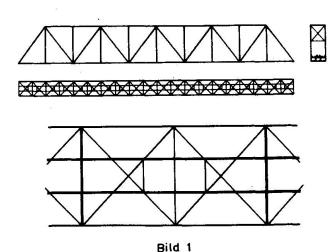
Einige Plattenbauelemente der üblichen kreuzförmigen Längsverbände verwandelte man durch den Einbau zusätzlicher Abstandhalter in unveränderliche Horizontalaussteifungen, die die Längsbalken in die Verbundwirkung mit den Gurten der Binder einbeziehen. Die Entlastung der entsprechenden Untergurte durch die Längsbalken beträgt 25 bis 35 %.
