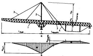
STARRES HÄNGEWERKSYSTEM MIT VORSPANNUNG AN EINER ABRAUM-FÖRDERBRÜCKE
