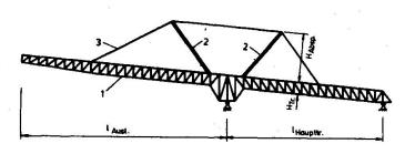
STARRES HÄNGEWERKSYSTEM MIT VORSPANNUNG AN EINER ABRAUM-FÖRDERBRÜCKE
