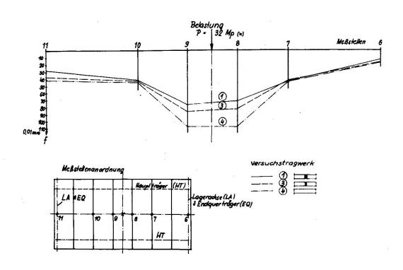
Abb. 2: Vergleich der Plattendurchbiegungen f längs der Mittellängsachse der Versuchstragwerke 1, 3 und 4
