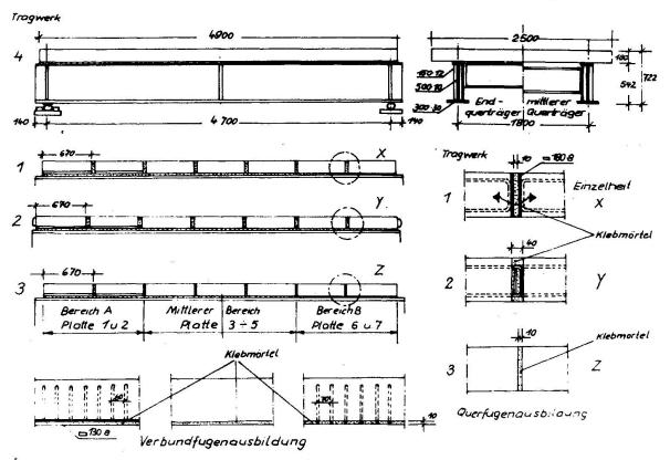
Abb. 1: Konstruktive Ausbildung der Versuchstragwerke
