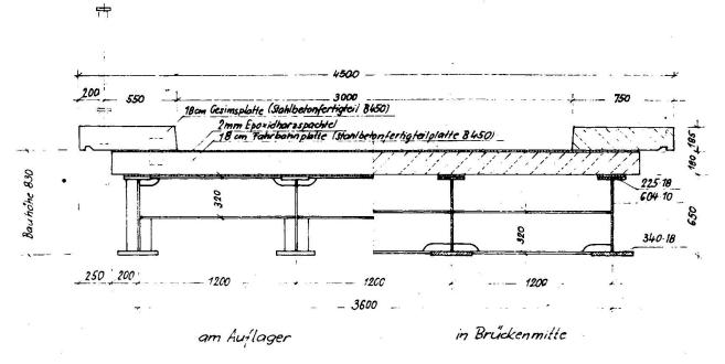
Abb. 4 Verbundbrücke mit geklebten Fertigteilen und Epoxidharzbeschichtung (Mühlgrabenbrücke in Görlitz). Stützweite 1 = 17 m
