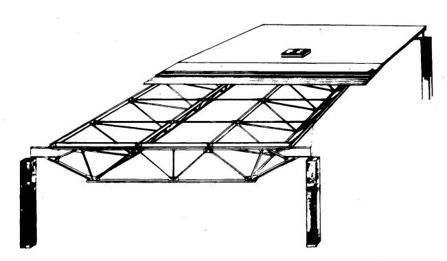
Bild 2 Dachkonstruktion ohne Pfetten und Verbände, die profilierten Bleche verlaufen parallel zu First und Traufe.
