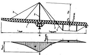
STARRES HÄNGEWERKSYSTEM MIT VORSPANNUNG AN EINER ABRAUM-FÖRDERBRÜCKE
