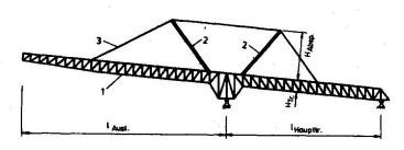
STARRES HÄNGEWERKSYSTEM MIT VORSPANNUNG AN EINER ABRAUM-FÖRDERBRÜCKE
