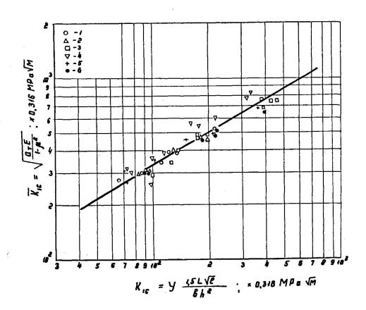
Abb. 5: Graphische Darstellung der Abhängigkeit der Parameter  $K_{\text{Ic}}$  und  $K_{\text{Ic}}$ , jeweils nach den Formeln (5) und (6) berechnet
