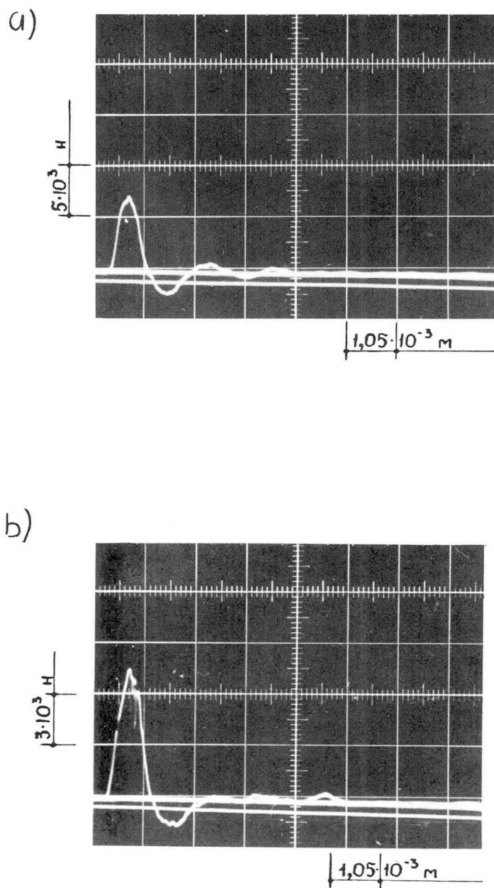
Abb. 4: Typische Oszillogramme "Last-Durchbiegung" bei dynamischer Belastung an Charpyprüfkörpern mit Ermüdungsriß bei einer Temperatur von  $-60^{\circ}\text{C}$
