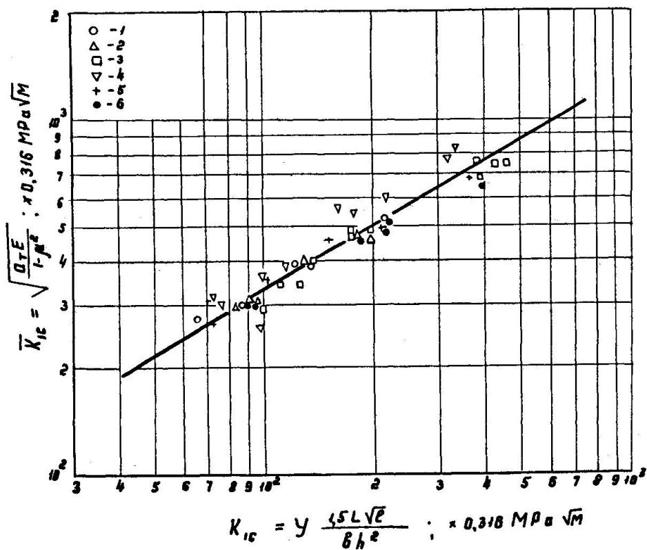
Abb. 5: Graphische Darstellung der Abhängigkeit der Parameter  $K_{Ic}$  und  $\bar{K}_{Ic}$ , jeweils nach den Formeln (5) und (6) berechnet
