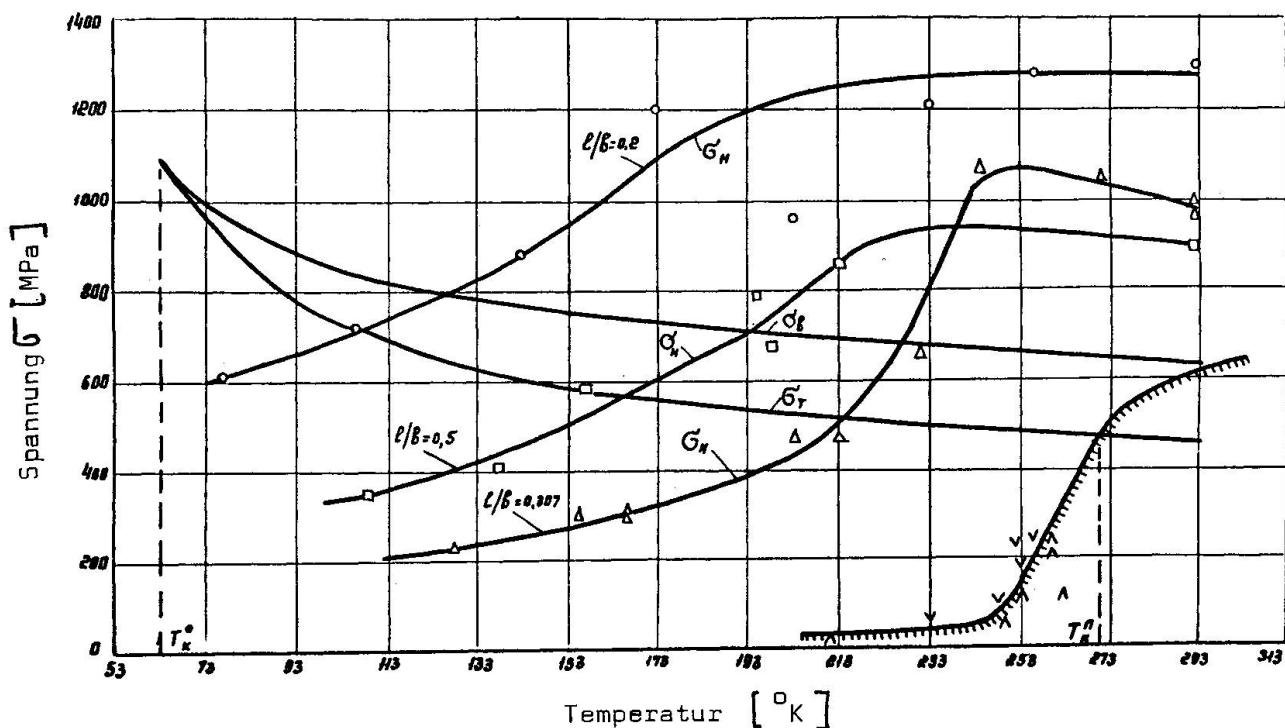
Abb. 1: Einfluß der Temperatur und der Fehlerabmessung auf die Sprödbruchfestigkeit des Stahles 4 bei statischer Belastung
