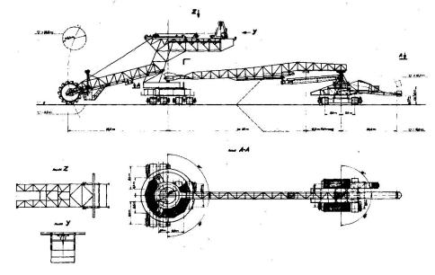
Bild 3: Schaufelradbagger SRs 1300
