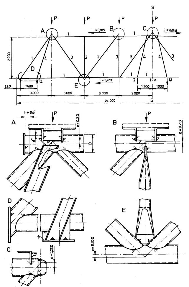
Abb. 2 Geometrisches Schema und Knoten untersuchter Binder aus Hohlprofilen mit rundem Querschnitt
