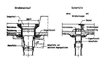
Bild 1: Brückeneinläufe und Sickertüllen (System WAL)
