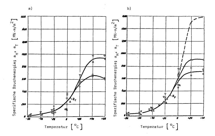
Abb. 3: Einfluß der Temperatur, der Fehlerabmessung und der Querschnittsabmessungen auf die spezifische Energie der Rißausbreitung der Stähle 1 und 4 bei dynamischer Belastung
