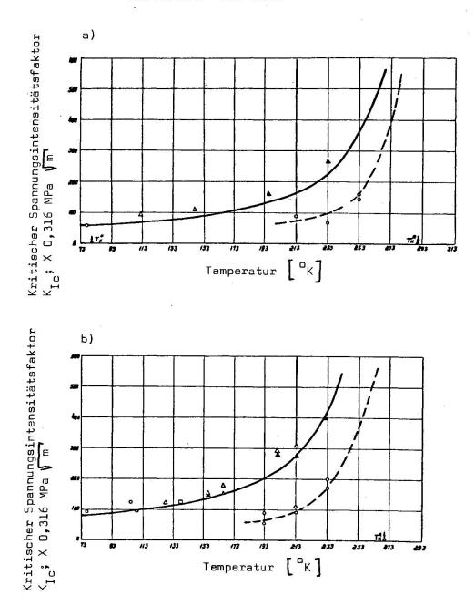
Abb. 6: Temperaturabhängigkeiten der kritischen Spannungsintensitätsfaktoren K<sub>Ic</sub> bei statischer (——) und dynamischer
