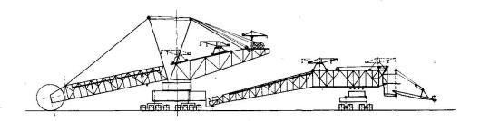
Bild 4: Krananlage des Großschaufelradbaggers SRs 6300
