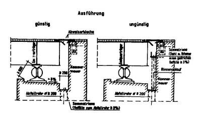
Bild 3: Entwässerung offener Fahrbahnübergänge
