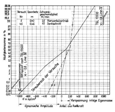
Bild 4: Spannungskollektiv für einen Obergurtstab des Ballastauslegers Meßstelle 52
