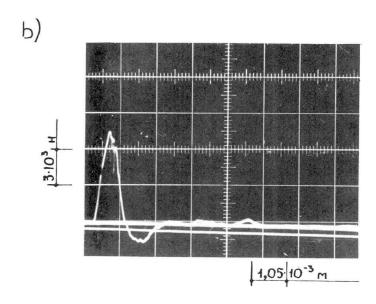
Abb. 4: Typische Oszillogramme "Last-Durchbiegung" bei dynamischer Belastung an Charpyprüfkörpern mit Ermüdungsriß bei einer Temperatur von - 60°C
