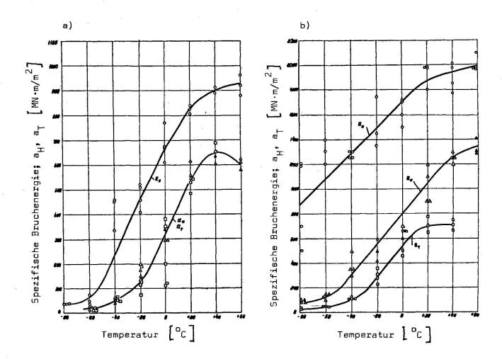
Abb. 2: Einfluß der Temperatur und der Kerbschärfe auf die spezifische Bruchenergie der Stähle 1 und 4 bei dynamischer Belastung
