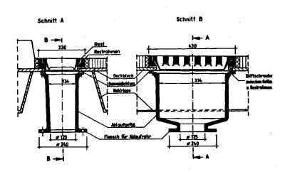
Bild 2: Brückeneinläufe für orthotrope Stahlfahrbahnplatten
