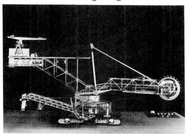
Bild 3: Schaufelradbagger SRs (K) 2000 (Modell)
