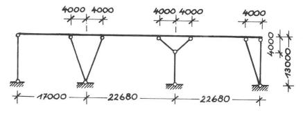
Bild 5: Statisches System der Gießkranbahn eines E-Stahlwerks
