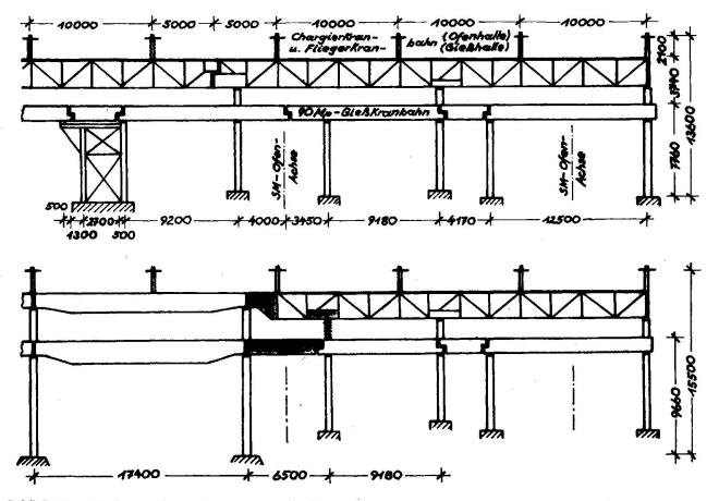
Bild 2: Umbau der inneren Stützenreihe eines SM-Stahlwerks
