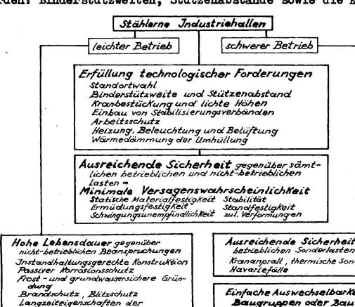
WirtschaftlichKeit der Stahlkon struktion + Gründung + Umhüllung: minimaler Projektierungs-, Fertigungs-, Montage - und Unterhaltungsaufwand
