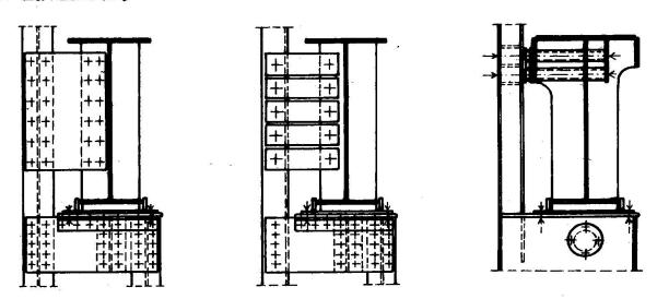
Bild 7a Bild 7b Bild 7c Kranbahnträgerauflagerungen mit horizontaler Verankerung
