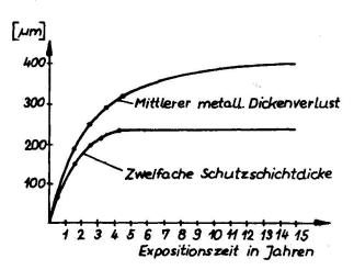
Abb.1 Schutzschichtbildung und Abnahme der metall. Dicke in Relation zur Expositionszeit
