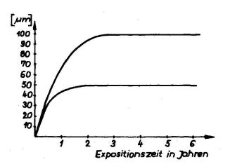
Abb. 2 Schutzschichtbildung bei freier Bewitterung und bei Innenraumbeanspruchung
