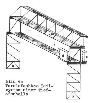
Bei der Erneuerung der Tiefofenkranbahn e/f konnte die Funktionstrennung nicht erreicht werden, weil die mögliche Systembreite für den Obergurt f zwischen Giebelwand und Kranlichtraumprofil nicht ausreichte, um den Träger zur Aufnahme aller Kranseitenkräfte genügend steif zu machen.
