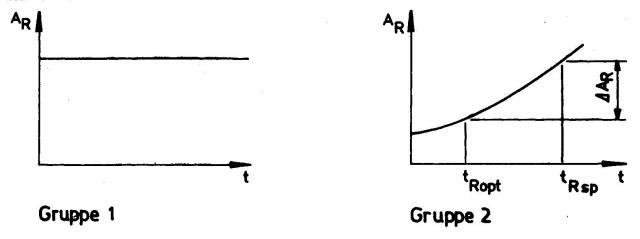
Bild 3 Die zwei Gruppen von Bauschäden
