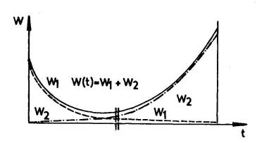
Bild 1 Schematische Darstellung der Wahrscheinlichkeit für das Auftreten von Bauschäden in Abhängigkeit vom Bauwerksalter
