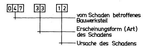
Bild 2 Klassifizierung der Bauschäden
