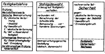
Bild 1 Schema der "Festigkeits-(Sicherheitsnachweise" Solche Sicherheitsnachweise ermöglichen in letzter
