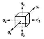
Beispiele für  $\pi$ :  $\pi$ -2 ,  $(-\sigma_1)$ =  $(-\sigma_2)$ =  $(-\sigma_3)$  dreiachsiger Druck  $\pi$ -1 ,  $\sigma_1$ ,  $\sigma_2$ = $\sigma_3$ =0 einachsiger Zug  $\pi$ -067 ,  $\sigma_k$ =2,4 DVM-Kerbschlagprobe  $\pi$ -0 ,  $\sigma_1$ = $\sigma_2$ = $\sigma_3$  dreiachsiger Zug Bild 5 Mehrachsigkeitszahl
