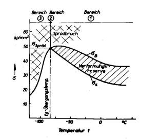
Bild 9 Einfluß der Temperatur auf die Bruchfestigkeit (&) und Streckgrenze (&) eines Stahls St 38 b-2
