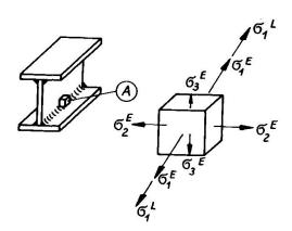
Bild 8 Beispiel für mehrachsigen Spannungszustand in einem
