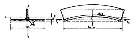
Abb. 4: Krümmung infolge außermittiger Längsschrumpfung
