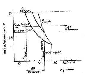
Bild 10 Einfluß der Mehrachsigkeit Bild 11 des Spannungs-Zustandes auf die Übergangs-Temperatur von Stählen
