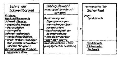
Bild 3 Schema des Sprödbruch-(Sicherheits)-Nachweises
