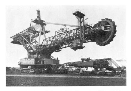
Bild 2: Schaufelradbagger SRs 2000
