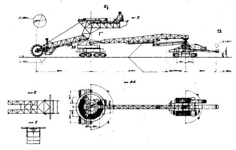
Bild 3: Schaufelradbagger SRs 1300
