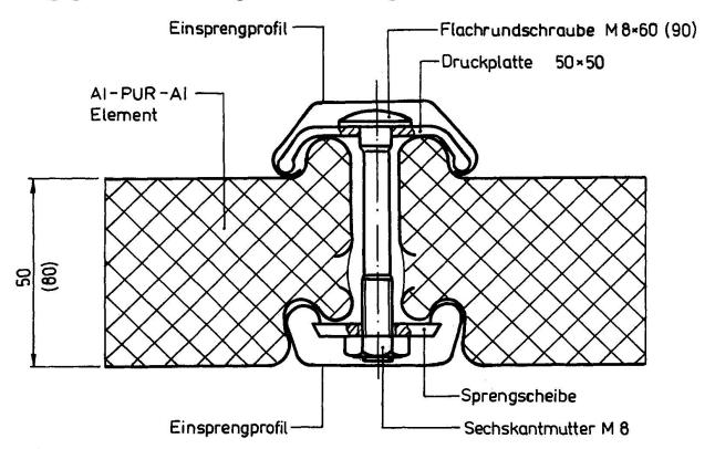
Bild 1: Fugenlösung des VEB Holzbauwerke Bernsdorf für AL-PUR-AL-Sandwichelemente
