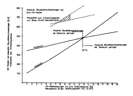
Bild 6: Vergleich absoluter Baustellenaufwendungen für teilund vollgeschützte Stahlkonstruktionen in Abhängigkeit vom Beschädigungsgrad
