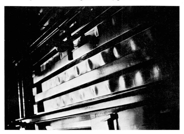
Bild 4: Beulfiguren in einer Versuchstafel kurz vor dem Versagen
