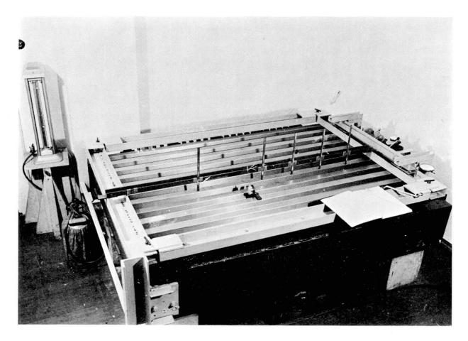
Bild 3: Versuchseinrichtung zur Tragfähigkeitsprüfung von profilierten Blechtafeln unter kombinierter Quer- und Schubbelastung mittels Schubrahmen und Luftkissen (Manometer am linken Bildrand)
