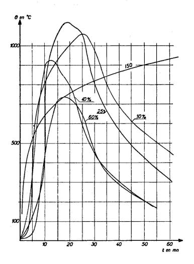
Températures moyennes enregistrées dans un four d'essais pour une même charge calorifique (30 kg/m<sup>2</sup>) et pour différents taux de ventilation, comparées au programme thermique normalisé.
