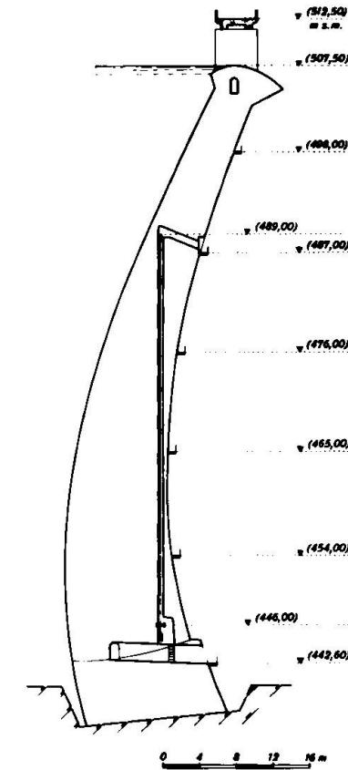
Barrage de Talvacchia. Installation du pendule.
