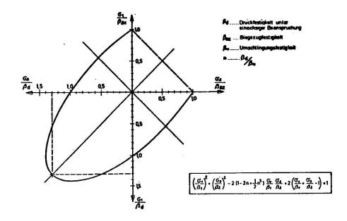
Mit dieser Ellipse ist die Bruchgrenzkurve des Betons in den drei Quadranten (Druck-Druck und Druck-Zug) definiert. Mangels genauerer Unterlagen könnte im vierten Quadranten, dem Zug-Zugbereich, zunächst eine geradlinige Verbindung der beiden Eckpunkte der Bruchgrenzlinie für einachsige Beanspruchungen angenommen werden (Abb.1)
