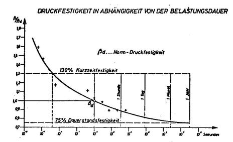
Die Dauerstandsfestigkeit des Betons dürfte bei 75 % der Normendruckfestigkeit liegen; dabei wird der Versuchskörper ständig der späteren Bruchlast unterworfen. In der Praxis erreicht die Dauerlast höchstens den zulässigen Teil der Bruchlast, die erforderliche Abminderung wird also wesentlich geringer sein.
