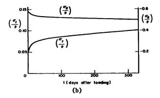
Fig. 8.  $\sigma_r$  and  $\sigma_t$  in thick cylinder at various values of t' and t;  $r = r_2$ . Fig. 8.  $\sigma_r$  et  $\sigma_t$  dans un cylindre épais à des valeurs diverses de t' et de t;  $r = r_2$ .
