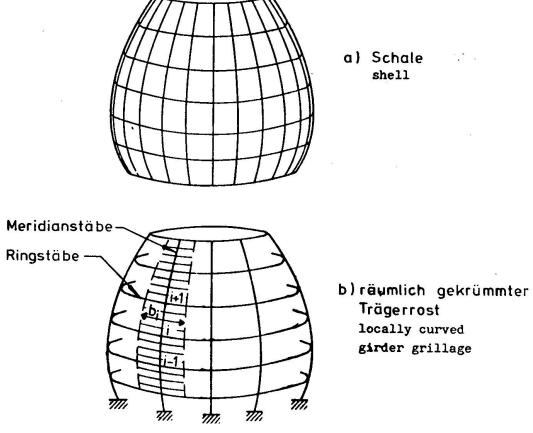
Bild 3: Von der Schale zum räumlich gekrümmten Trägerrost From the shell to the locally curved girder grillage
