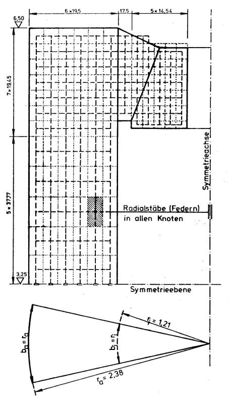
Bild 15: Statisches Ersatz-System Equivalent static system
