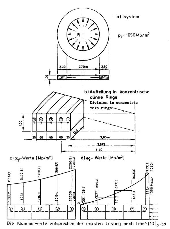
Bild 9: Dickwandiger Kreisring unter Innendruck Circle ring with thick walls under internal pressure
