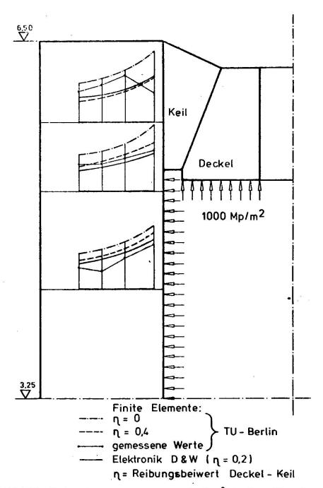
Bild 17: Betonringspannungen & kp/cm² im Schaftbereich,
