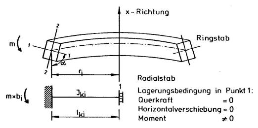
Bild 7: Bedingung zur Bestimmung des Trägheitsmoments
