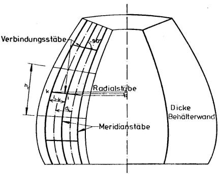
Bild 8: Unterteilung der dickwandigen Schale in zB. 3konzentrisch dünne Schalen
