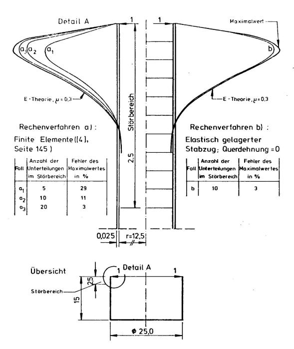
Bild 5: Fehler verschiedener Rechenverfahren in % Bezogen auf die exakte Lösung am Beispiel einer randbelasteten Zylinderschale
