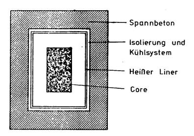
Bild 2: Spannbeton-Druckbehälter
