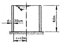
Bild 11: Zylindrischer Wasserbehälter cylindrical water reservoir
