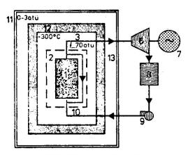
d. SIEDEWASSERREAKTOR Boiling water reactor (LEICHTWASSERREAKTOR) (Light water reactor)
