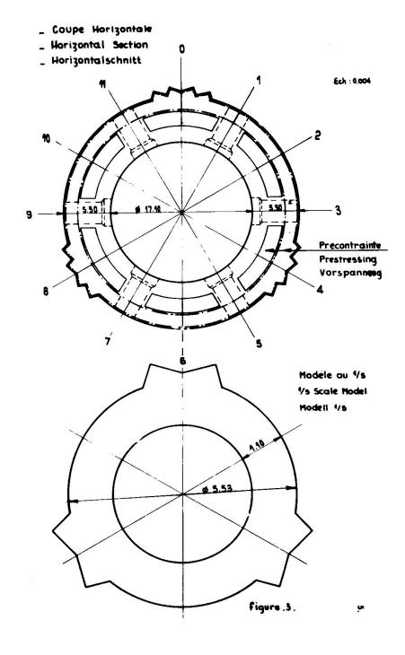
Le coefficient de frottement des câbles de précontrainte dans leurs gaines a été mesuré sur un banc circulaire de diamètre comparable à celui du caisson. La valeur de 0,18 a été retenue.
