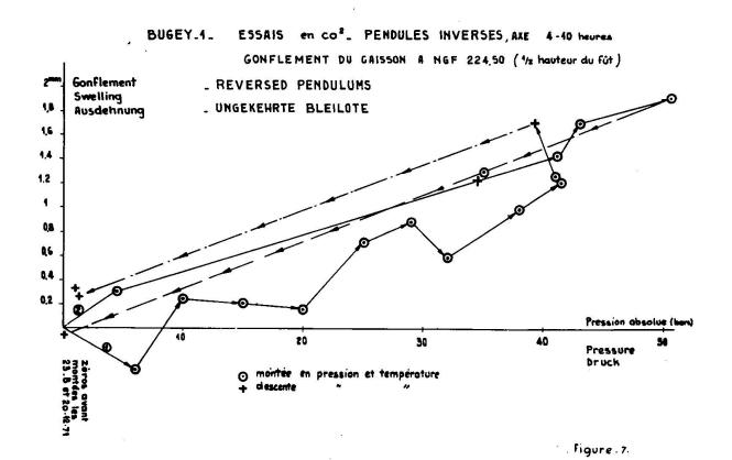
Les déformations enregistrées par les jauges collées sur le métal et les témoins sonores noyés dans le béton les plus proches étaient remarquablement concordantes (651 x 10<sup>-6</sup> et 624 x 10<sup>-6</sup> pour  $\sigma_{C}$  par exemple). Il y a une correspondance convenable entre calculs et mesure si l'on affecte au béton un module de déformation partiellement différé de 250 000 b à cette époque, cette dernière valeur étant par ailleurs en accord avec les indications des dynamomètres.
