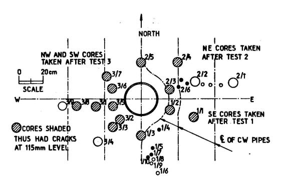
FIG.13 POSITIONS OF CORES TAKEN FROM MODEL
