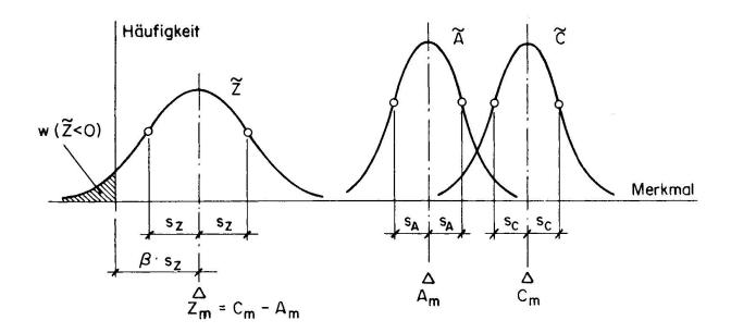
Bild 4: Die Sicherheitsforderung bei normalverteilten Ausgangsgrössen
