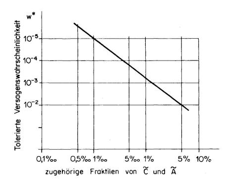
Bild 5: Zusammenhang zwischen tolerierter Versagenswahrscheinlichkeit w\* und den zugehörigen Fraktilen von C und A
