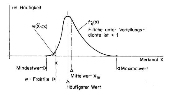
Bild 2: Verteilungsdichte einer stochastischen Grösse mit Wahrscheinlichkeit w für das Auftreten von Werten  $\widetilde{X}$  < X
