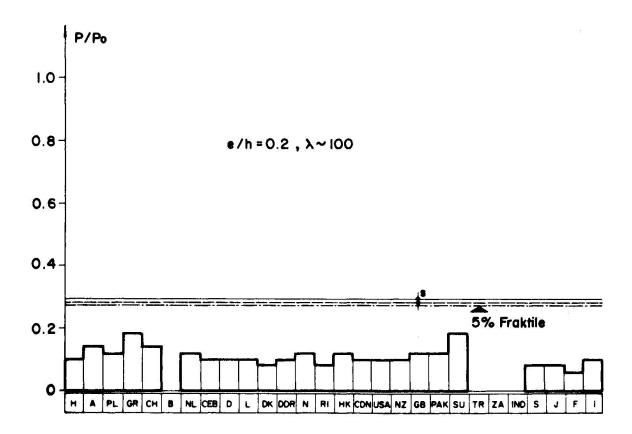
Fig. 7 Traglasten und zulässige Lasten  $P_0 = A_c \cdot f_c + (A_s + A_s^1)$  Gy
