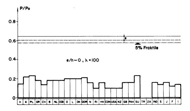
Fig. 6 Traglasten und zulässige Lasten Po =  $A_c \cdot f_c + (A_s + A_s^{\dagger})$  Gy
