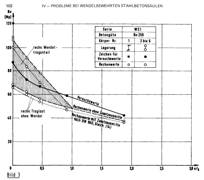
Einfluß einer vorgegebenen Exzentrizität auf die Höchstlast wendelbewehrter Stahlbetonsäulen - Vergleich von Versuchswerten nach DIN 1045 (aus Lit. 3)
