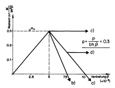
Bild 2: Schematische Momenten-Verdrehungsbeziehung
