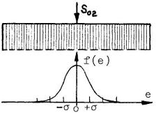
Abb.1: "Mittig" belastete Stahlbetonstütze
