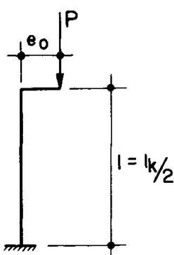
Die Schwierigkeit der Traglastberechnung für eine einfache Stütze gemäss Fig. 1 besteht vor allem darin, dass bei der Laststeigerung die Querschnittssteifigkeit auf der ganzen Stützenhöhe ständig ändert; d.h. jedem Schnittkraftpaar  $N$  und  $M$  entspricht eine bestimmte Steifigkeit  $EI$ . Diese spezifische Steifigkeit lässt sich im Prinzip aus den Arbeitslinien für Stahl (Fig. 2) und Beton (Fig. 3) berechnen.
