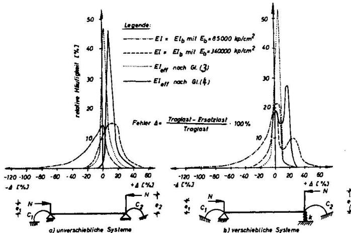
Abb. 2 Fehlercharakteristik des Ersatzstabverfahrens
