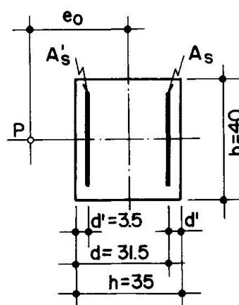
Fig. 5 Querschnitt  $A_c = 35 \times 40 \text{ cm}^2$
