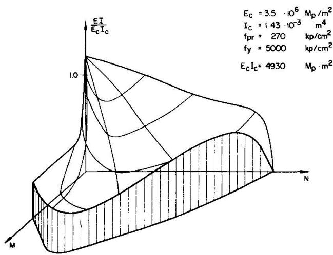
Fig. 4 Steifigkeit - Schnittkräfte ( $N, M$ )
