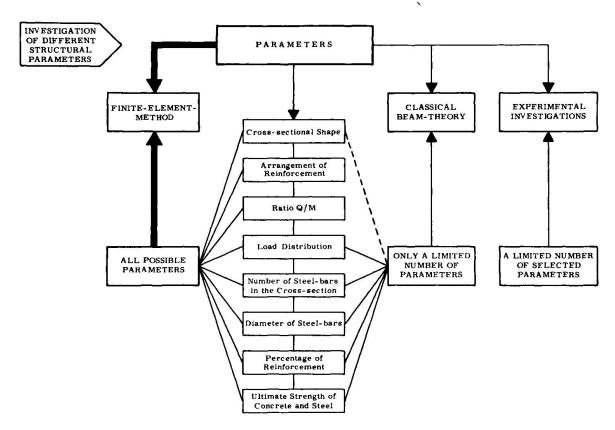
Bild 4: Untersuchung des Last-Verformungsverhaltens in Abhängigkeit verschiedener Einflußparameter
