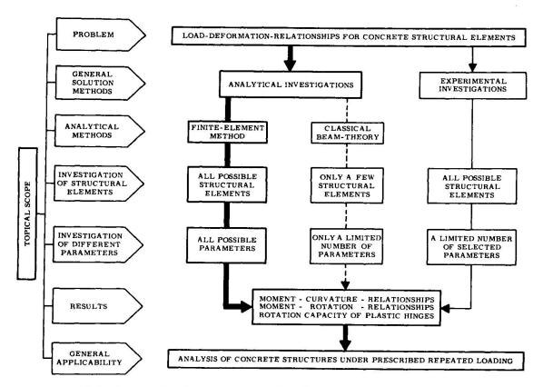
Bild 1: Methoden zur Ermittlung von Last-Verformungsbeziehungen
