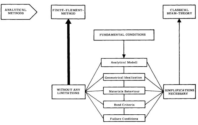
Bild 2: Kriterien zur Auswahl geeigneter Rechenverfahren
