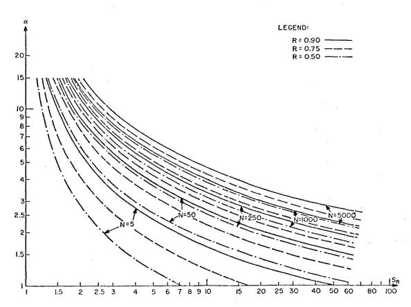
FIGURE 2 SHAPE PARAMETER VERSUS SCATTER FACTOR
