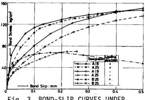
Fig. 3. BOND-SLIP CURVES UNDER MONO. LOADING
