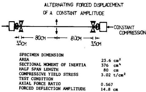
Fig. 5 SIMPLE BEAM SPECIMEN
