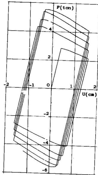
Fig. 6 COMPUTED LOAD-DEFLECTION CURVE FOR SIMPLE BEAM SPECIMEN
