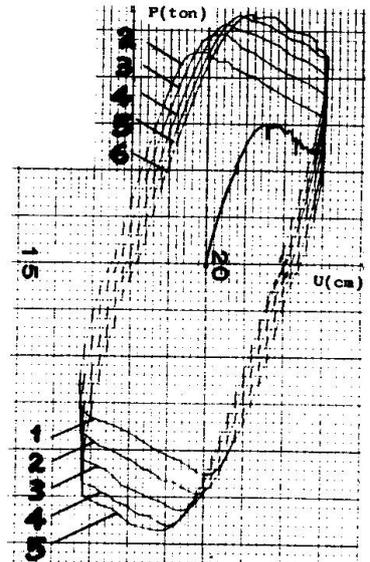
Fig. 7 EXPERIMENTAL LOAD-DEFLECTION CURVE FOR SIMPLE BEAM SPECIMEN
