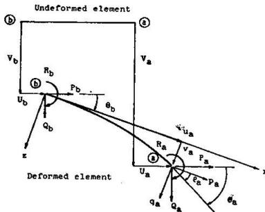
Fig. 2 LOCAL AND GLOBAL COORDINATES FOR AN ELEMENT
