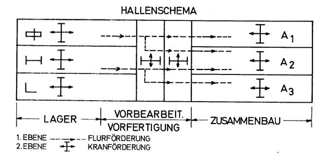
Bild 3 zeigt die Realisierung des in Bild 2 gezeigten Ablaufschemas mit den Arbeitsrichtungen der Transportanlagen der 1. und 2. Ebene.
