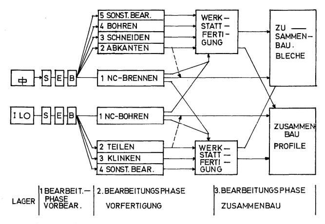
Bild 2 bringt schematisch den Fertigungsfluß und die Anordnung der Bearbeitungsanlagen bei Kombination von Fließfertigung und Werkstattfertigung.
