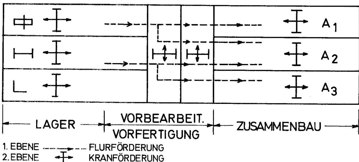
Bild 3 zeigt die Realisierung des in Bild 2 gezeigten Ablaufschemas mit den Arbeitsrichtungen der Transportanlagen der 1. und 2. Ebene.
