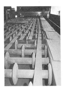
können an bestimmten Einsatzstellen durch Transportbänder oder Wanderrostförderer ersetzt werden. (Bilder 7 a und 7 b)
