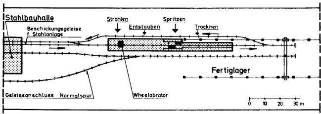
Abb.3 Disposition einer halbautomatischen Stahl-, Spritz- und Trockenanlage.
