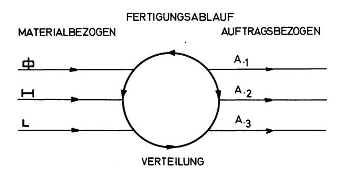
Bild 1 zeigt schematisch den Materialfluß vom Vormateriallager, dessen Linien formbezogen sind, über die als Kreis angedeutete erforderliche Verteilung auf die auftragsbezogenen Fertigungslinien. Dabei sollte innerhalb der Verteilungszone die Einzelteilbearbeitung vorgenommen werden. KNUT REIMERS
