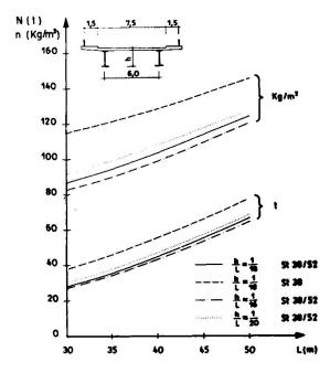
Bild 1 Stahlbedarf für die Stahlkonstruktion von Typ III
