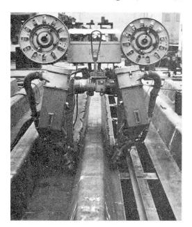
Fig. 7. Verschweissen der Hohlrippen mit Deckblech.
