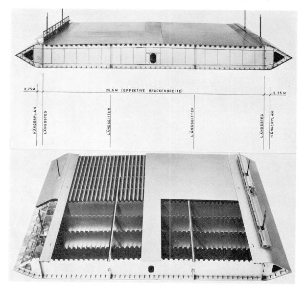
Fig. 2. Querschnitt und Aufbau des Stahlhohlkastens, Modell.
