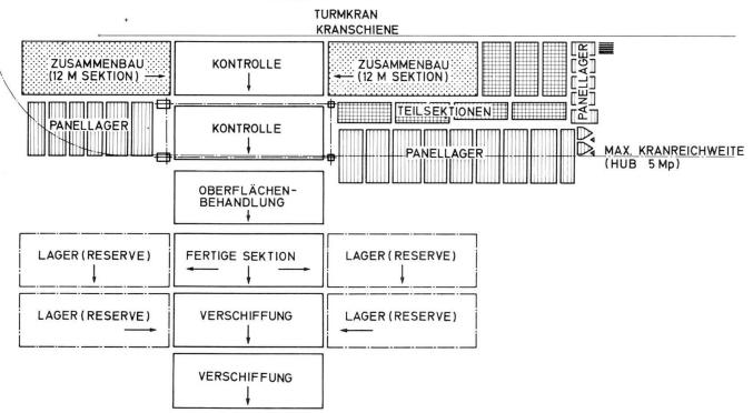
Fig. 5. Sektionszusammenbau, Fertigungslinie.
