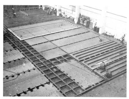
Fig. 3. Panelfertigung. Im Hintergrund Deck- und Bodenpanele, im Bild vorne Längs- und Querstege ausgelegt.
