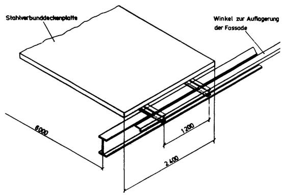
Bild 4 Anschluß der Stahlverbunddeckenplatte an die Haupttragkonstruktion mit überstehenden Verbundträgern
