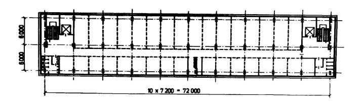
Bild 1 Grundriß eines Normalgeschosses
