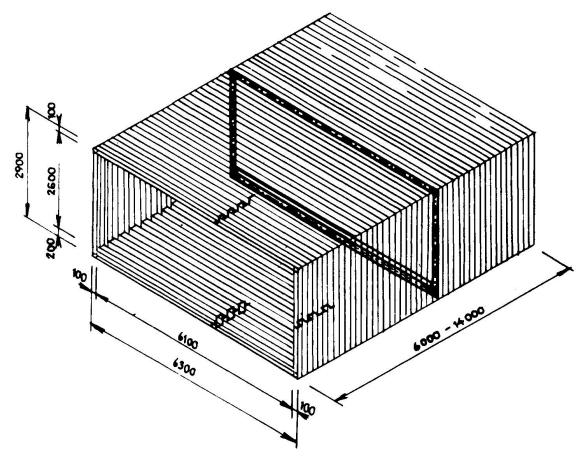
Abb. 2. Axonometrisches Schema der Zellenkonstruktion
