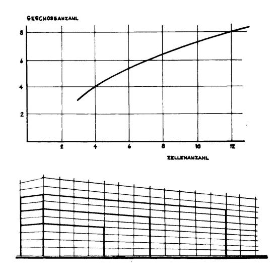
Abb. 7. Graph der Abhängigkeit der Objektlänge von der Höhe bei konstanter längsliegender Winddruckbeanspruchung
