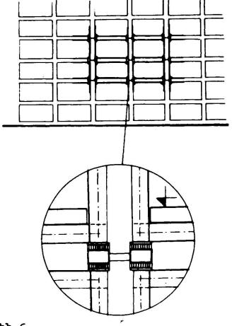
Abb.6. Statisches Schema des Konstruktionssystems
