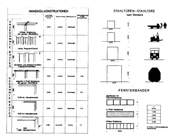
Leichte, wärmedämmende Außenwände bestehen aus AL- oder asbestzementbeschichteten Plastschaum-Verbundelementen, die vertikal auf Wandriegelkonstruktionen montiert werden. Diese sehr schnell montierbaren, sichtflächenfertigen Bauelemente, sind beliebig kombinierbar mit Lichtbändern oder Großflächen-verglasungen, z.B. als einscheibige, kittlose Verglasung oder doppeltstehende U-Profilverglasung, in die wahlweise Lüftungsflügel oder bei Doppelverglasung Thermoscheibenfenster aus
