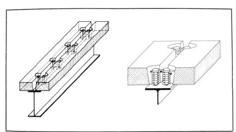
Bild 5: Verbund mit Kopfbolzen-dübeln.
