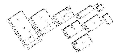
Bild 8: Zur Verwendung kommende Betonteile. Die drei mit Aussparung versehenen Platten decken alls vorkommenden Stützenstellungen ab.
