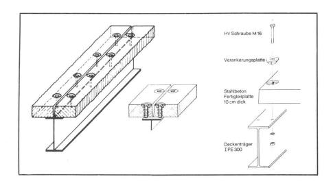
Bild 10: Reibungsverbund mit HV-Schrauben.
