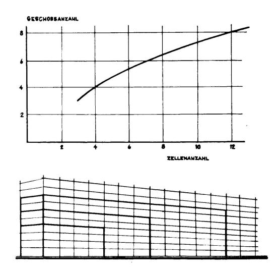
Abb. 7. Graph der Abhängigkeit der Objektlänge von der Höhe bei konstanter längsliegender Winddruckbeanspruchung
