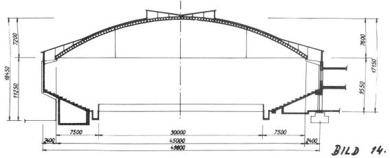
der 88 x 45m grossen Dachfläche in Poprad brauchte man 83,55 t Stahl, überwiegend Stahlrohre und das gibt einen sehr niedrigen Einheitswert von 21 kg/m².
