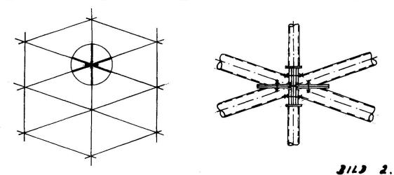
4 normale und 4 HV - Schrauben, was angemessen ist. Er ist sehr einfach und wegen seiner geraden Kontaktflächen ist er gerade sehr vorteilhaft für die Montagestösse direkt oben auf dem Dach. Die Mehrzahl von diesen Stössen kann natürlich schon auf der Erde durch Hilfsarbeiter bei der Zusammenstellung von grösseren Montageblöcken durchgeführt werden.
